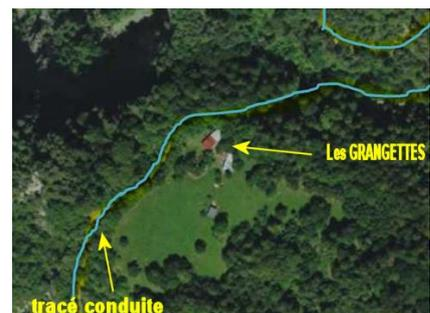
SHEMA apportera une attention particulière au passage de la conduite sur ce secteur. En particulier, la conduite sera enterrée au milieu du chemin anthropisé (d'une largeur de 3 m). Son diamètre a été optimisé afin de limiter les dimensions de la tranchée. Ainsi, la conduite aura un diamètre de 0,6 m, pour une tranchée de 1,8 m de profondeur et 1,5 m de large.
